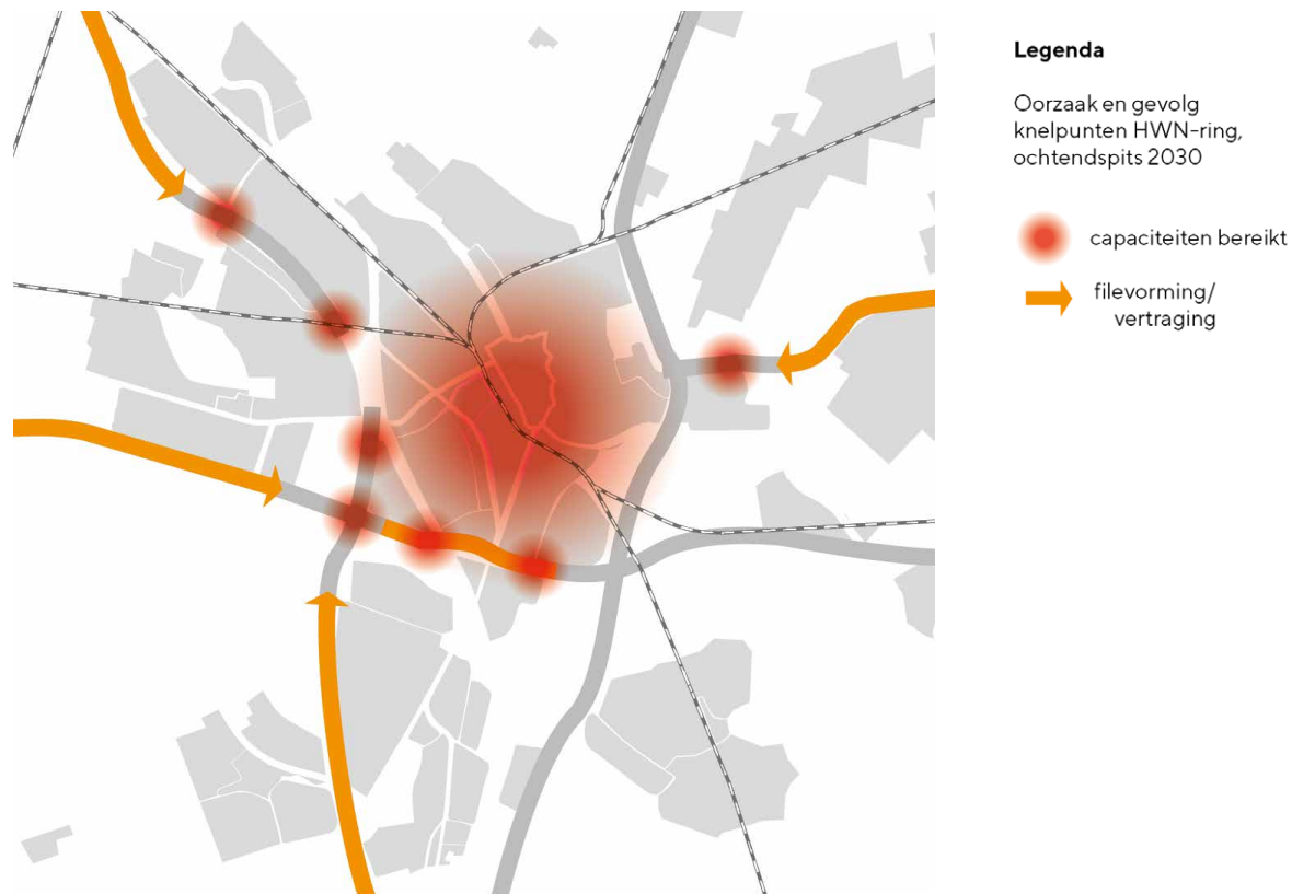
Afbeelding 10 - Deze figuur laat zien waar in 2030 in de ochtendspits de files ontstaan en wat de oorzaken zijn. De capaciteit van de aansluitingen en de weefvakken van de HWN-ring wordt overschreden, waardoor er lange wachtrijen ontstaan die alle rijbanen blokkeren.
